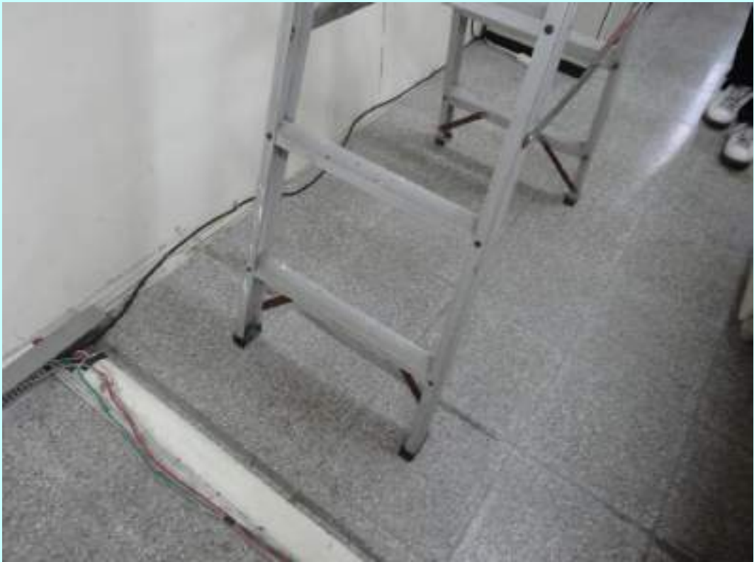
該合梯腳部有防滑絕緣腳座套（符合法規）
